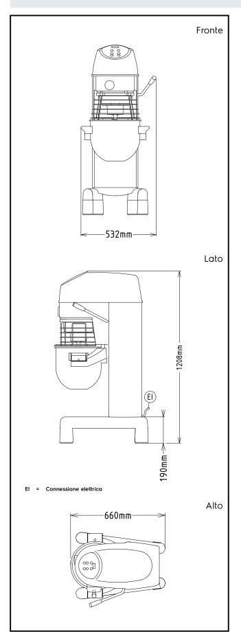
Elettrico Tensione di alimentazione: 200-240 V/1N ph/50/60 Hz Potenza installata max: 1.01 kW Capacità Prestazioni (fino a): 6 kg/ciclo Capacità 20 litri Informazioni chiave
